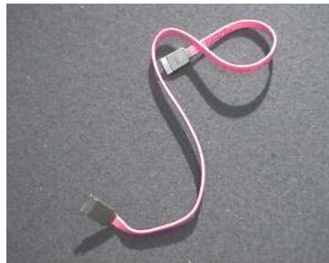
Fig 12 Cable de datos Serial ATA
