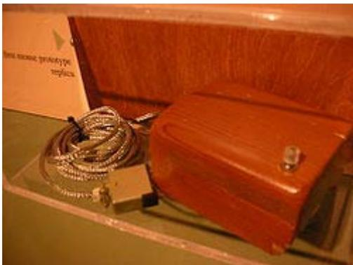
La primera maqueta se construyó de manera artesanal de madera, y se patentó con el nombre de "X-Y Position Indicator for a Display System".
